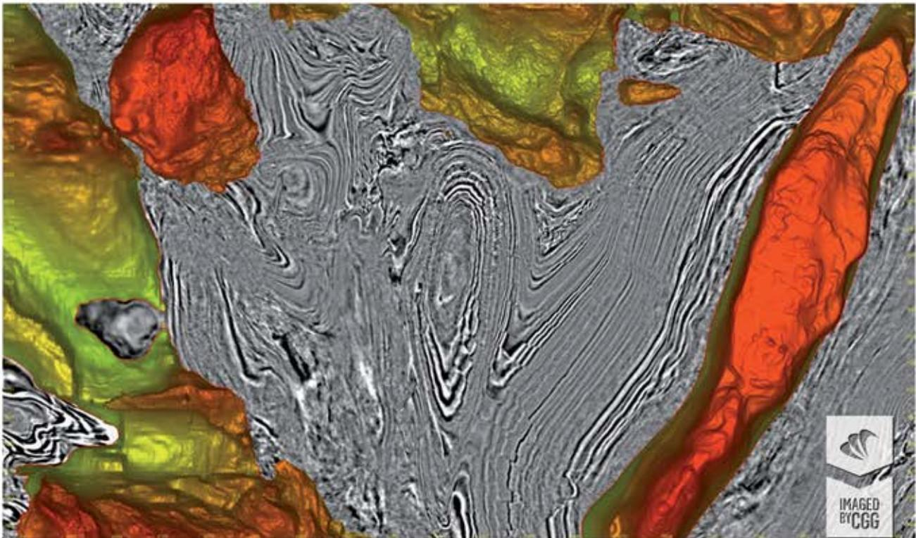
Corte en profundidad de un acimut amplio (WAZ) que muestra la parte superior de la sal y claramente la estructura geológica.
