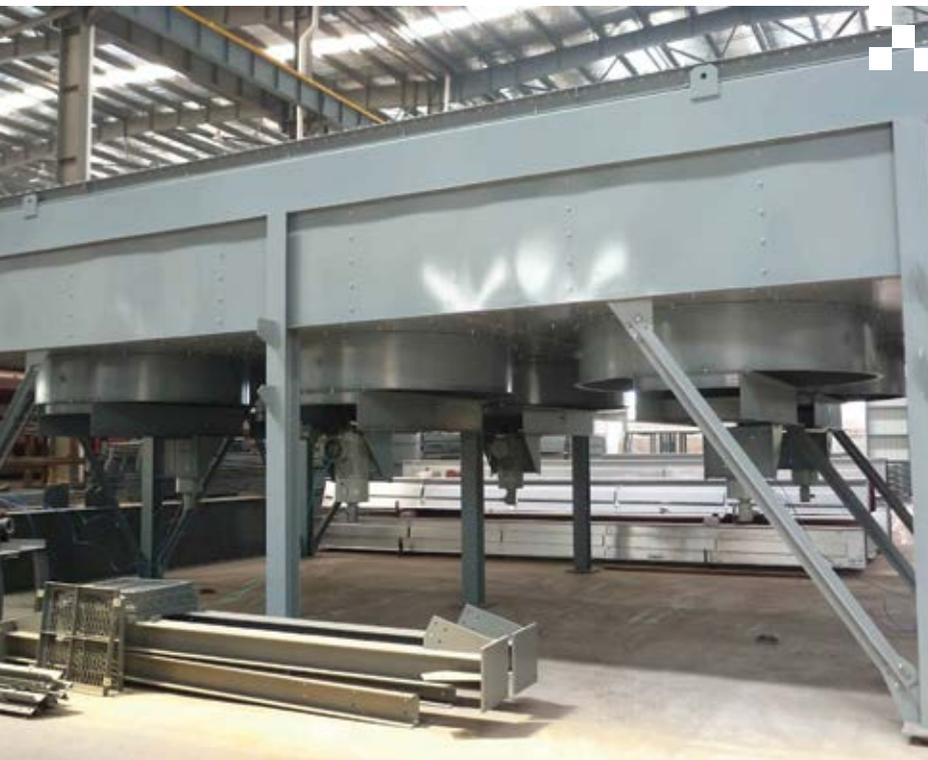
Con el aumento de restricciones ambientales y reglamentación sobre el uso del agua, los aerofriadores son una buena alternativa.
