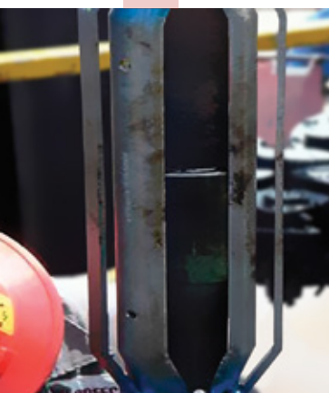
Figura 6. Abrazadera Centralizadora sobre el Cople.
