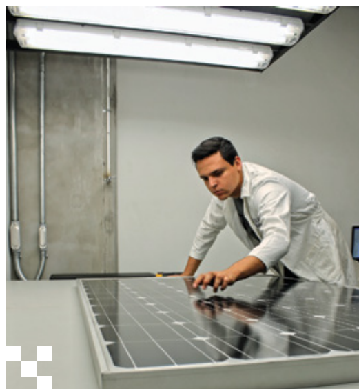
El ingeniero electromecánico Jorge Luis Carnalla Ortiz, evalúa la calidad de módulos fotovoltaicos.
