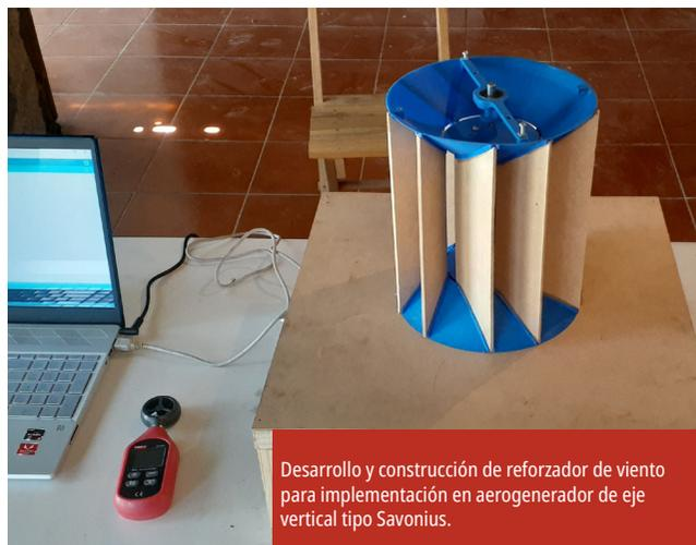
Desarrollo y construcción de reforzador de viento para implementación en aerogenerador de eje vertical tipo Savonius.
