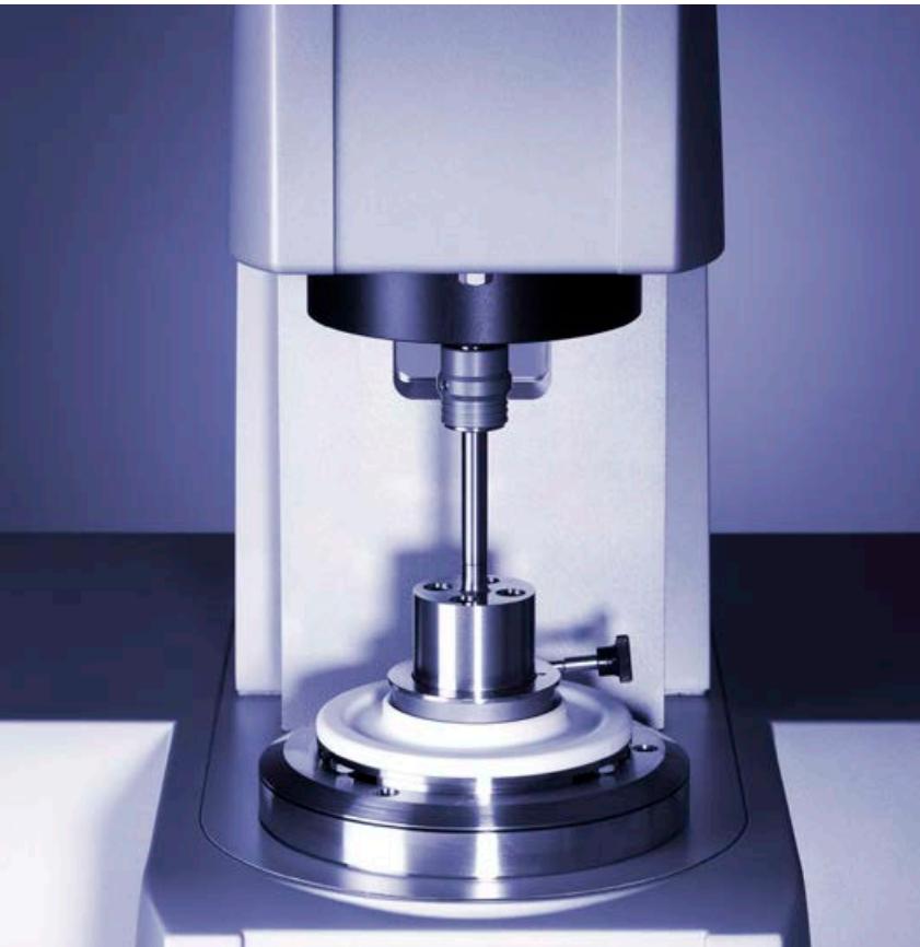
La celda de presión permite evaluar la viscosidad a velocidades más altas.
