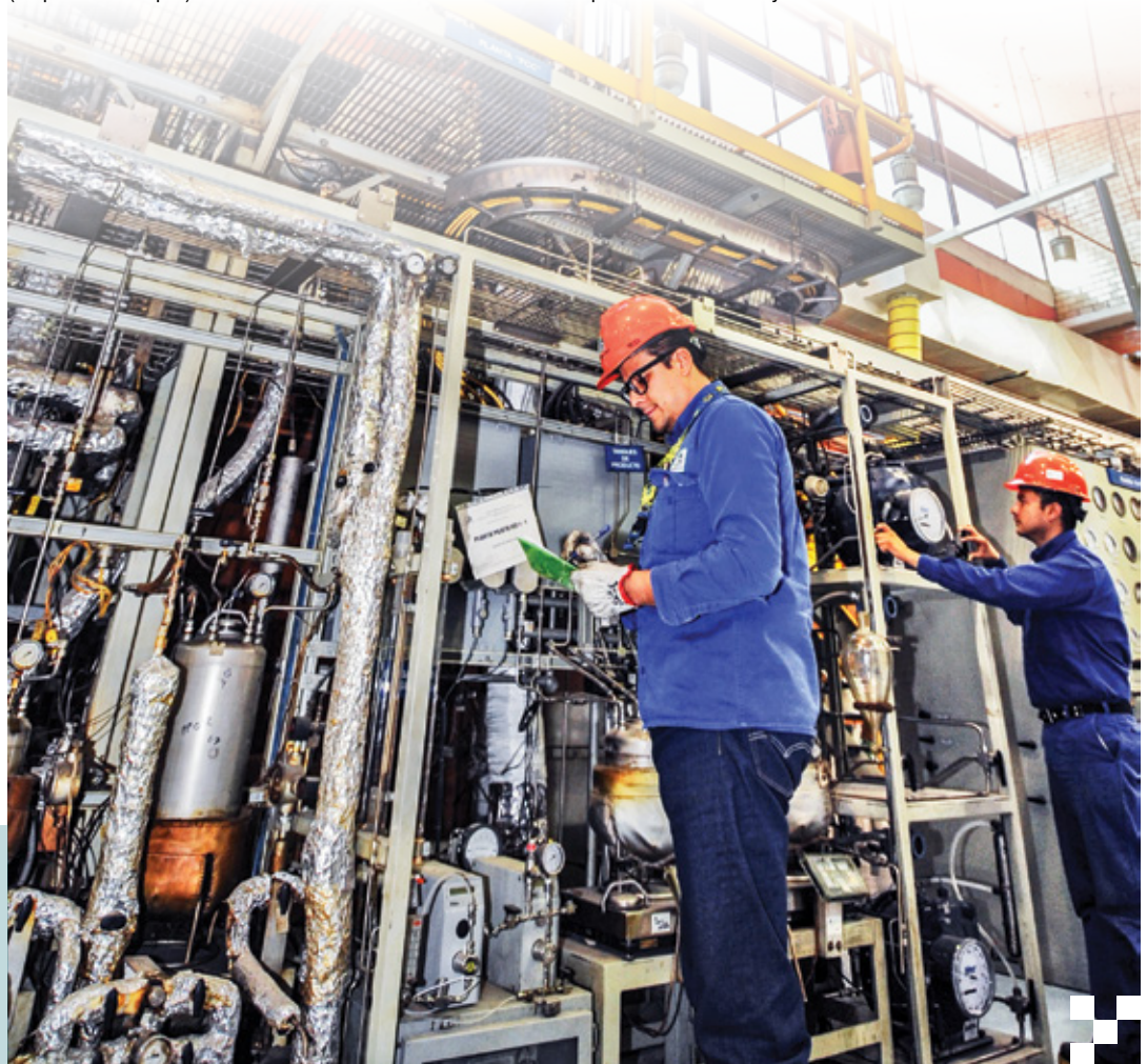
En la quinta etapa se realiza la evaluación del desempeño catalítico con las unidades micro y planta piloto (ACE-R y DCR) a diferentes relaciones de catalizador-aceite (C/O).
