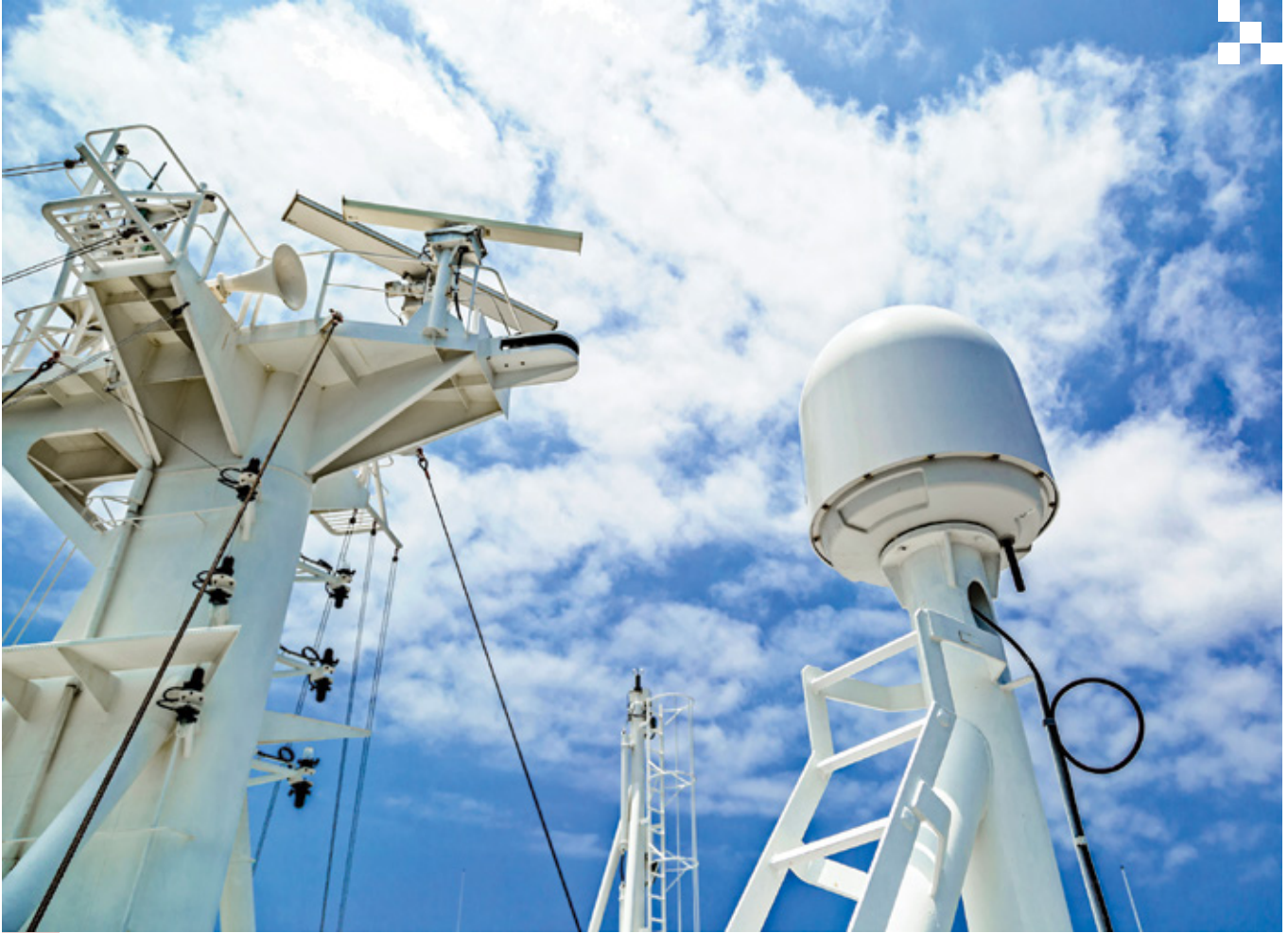
Antena satelital en embarcación que brinda comunicación en movimiento.
