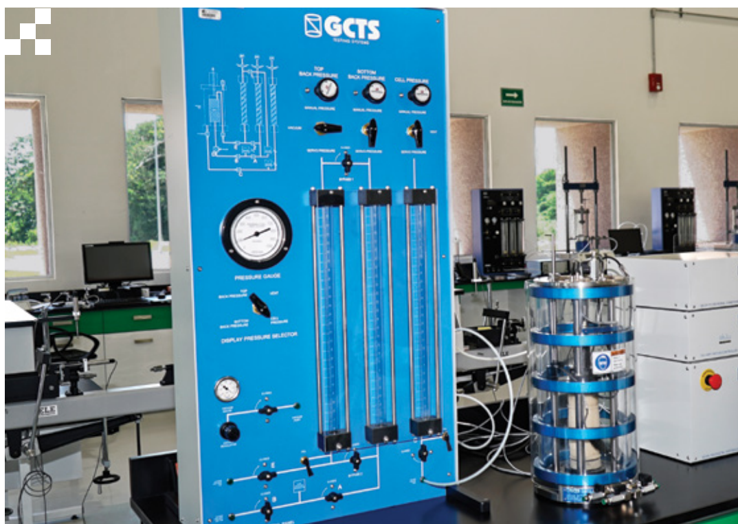
La columna resonante del Laboratorio de Geotecnia... permite medir propiedades dinámicas del suelo y conocer la respuesta del suelo ante sismos u oleaje.
